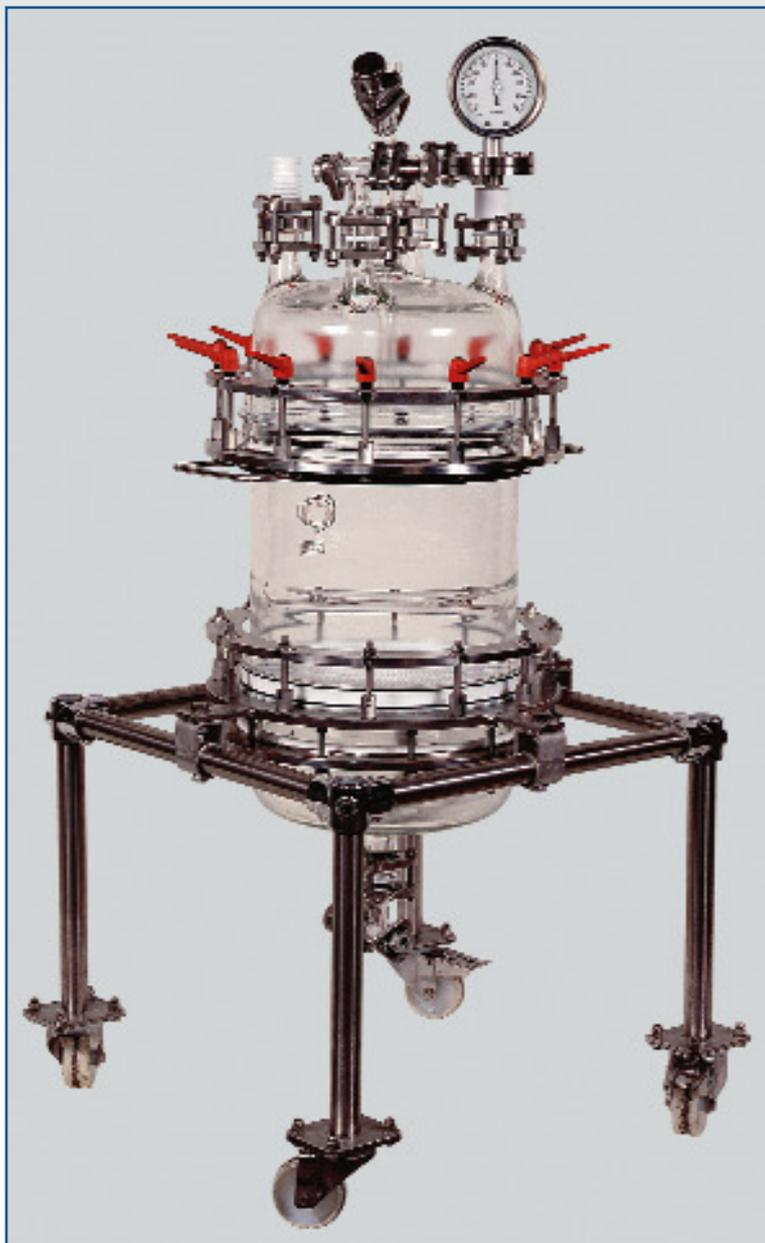
Нутч-фильтры используются для фильтрации под вакуумом в малотоннажном производстве. Нутч-фильтры имеют разборную конструкцию: между днищем и корпусом размещается слой фильтра. Выгрузка осадка может происходить сверху (после снятия верхней крышки) или снизу (отсоединяется днище).
