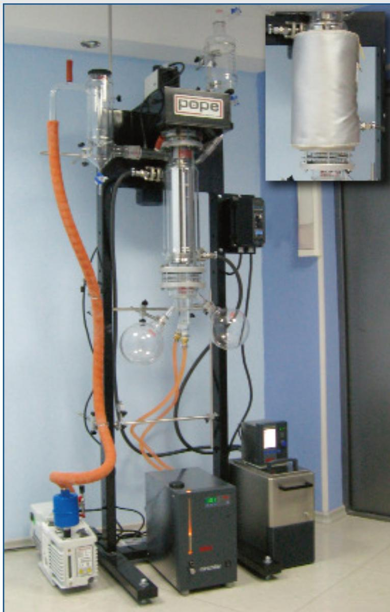
Тонкопленочные испарители применяются для процессов разделения, очистки, перегонки веществ, чувствительных к высоким температурам, особенно подходят для работы с вязкими остатками (до 5000 сПз). За счёт сокращения давления значительно снижается рабочая температура, кроме того, малое время контакта позволяет сохранять в первоначальном виде легкоразлагающиеся продукты, витамины, запахи, микроорганизмы и так далее.
