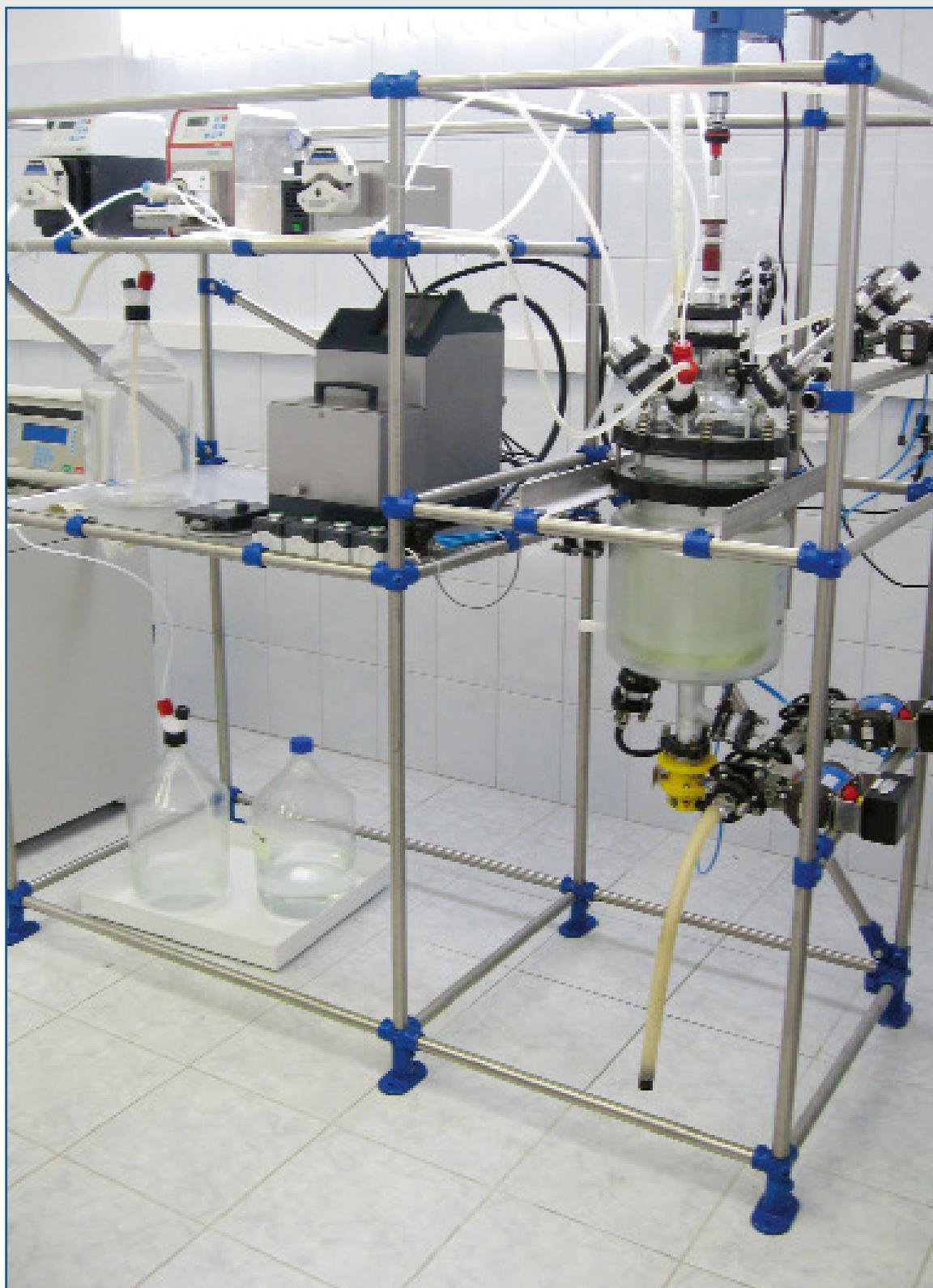
**Реактор:** 6л, цилиндрический, с рубашкой для термостатирования и вакуумной рубашкой, с донным сливом
