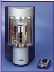
Тензиометры серии BP позволяют определять динамическое поверхностное натяжение по методу максимального давления в пузырьке. Тензиометр полностью автоматизирован, имеет встроенный компрессор, термостатируемую рубашку для поддержания температуры образца. Прибор имеет разъём для подключения к внешнему источнику газа, что используется для изучения поверхностного натяжения жидкостей в инертной атмосфере.
