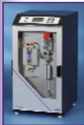
Тензиометр DVT50 измеряет динамическое межфазное натяжение как функцию от возраста поверхности. Это даёт важную информацию о кинетике и поверхностной активности органических жидкостей, ПАВ и т.п.
