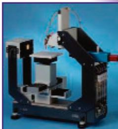
Особенностью приборов DSA30 является возможность проводить измерения при температурах от -60 до +400°C. Опционально поставляются камеры для поддержания температуры, влажности или инертной атмосферы. DSA30 имеет модуль для изучения поверхностной реологии (Oscillation Drop Module) висящей капли. Поставляется с программой DSA1 (сбор данных и обработка) или DSA3 (управление, сбор и обработка).
