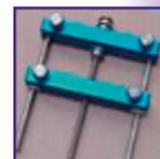
Для измерения смачиваемости порошков применяется держатель ST02, который представляет собой пластину с углублениями для образца.
