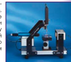
Модель EasyDrop USB имеет запатентованную систему дозирования с двумя шприцами, рычаг переключения помогает выбрать шприц с нужной жидкостью. Разработана для работы с ноутбуком.
