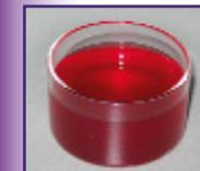
В комплект тензиометра включена одна стеклянная ёмкость. Рекомендуется иметь несколько сосудов для образцов, чтобы исключить загрязнение ПАВами. Стандартный стеклянный сосуд SV20 имеет диаметр 70 мм, есть ёмкость диаметром 50 мм (SV10), а также специальные ёмкости из PTFE.
