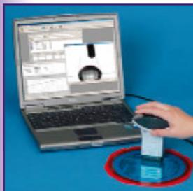
MobileDrop – компактный прибор для измерения краевого угла смачивания любых поверхностей, в том числе наклонных и вертикальных.
