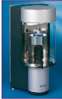
Тензиометры K100 поставляются с термостатируемой рубашкой, температура в которой поддерживается с помощью циркуляции теплоносителя, поступающего из жидкостного термостата<sup>1</sup>. Модульная система позволяет подобрать для работы необходимые приложения программного обеспечения (см. методы измерений) и рабочие элементы. Встроенный ионизатор снимает статическое электричество, которое может помешать измерениям.
