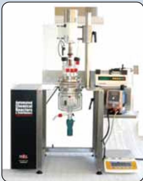
Прибор для точного моделирования и термического исследования химических реакций. Идеальный прибор для проведения разработок и исследований. Предназначен для определения скорости тепловыделения на протяжении всего эксперимента, позволяет рассчитать энтальпию реакции, коэффициенты теплопроводности и другие величины, дающие исчерпывающую информацию о термодинамике реакции.
