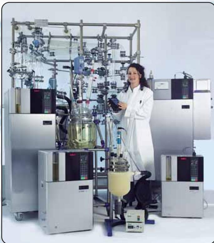
Для реакторов небольшого объема компания Huber предлагает невероятно компактные термостаты серии Ministat. Температурный диапазон этой серии от  $-40^{\circ}\text{C}$  до  $+200^{\circ}\text{C}$ . Они оснащены мощным насосом, а также внутренней ванной, что делает их универсальным и незаменимым помощником в любой лаборатории.
