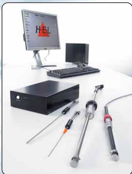
**Crystal Eyes** - полный контроль и документирование процесса кристаллизации. Система включает в себя набор зондов, всю необходимую электронику и ПК с программным обеспечением, готовым к работе.
