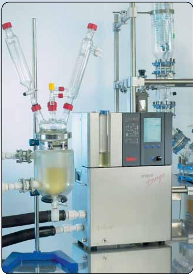
Лабораторные реакторы фирмы Lenz представляют собой сборное герметичное стеклянное оборудование, оснащаемое в соответствии с техническими заданиями термостатами, дозирующими насосами, диспергирующим и перемешивающим устройствами. Реакторы собираются на легких металлических стендах, что дает возможность как перемещать всю конструкцию целиком, так и свободно добираться до удаленных деталей.
