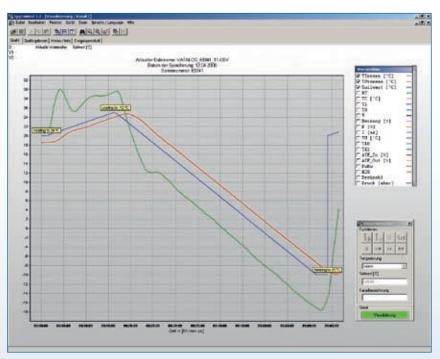
Процесс темперирования в реакторе, использование гатр-функции (20 литров, теплоноситель DW Therm)
