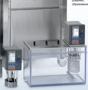
Шик: Циркуляторы в корпусе из нержавеющей стали, с взаимозаменяемый СС-Pilot или недорогая альтернатива с новым блоком управления МРС
