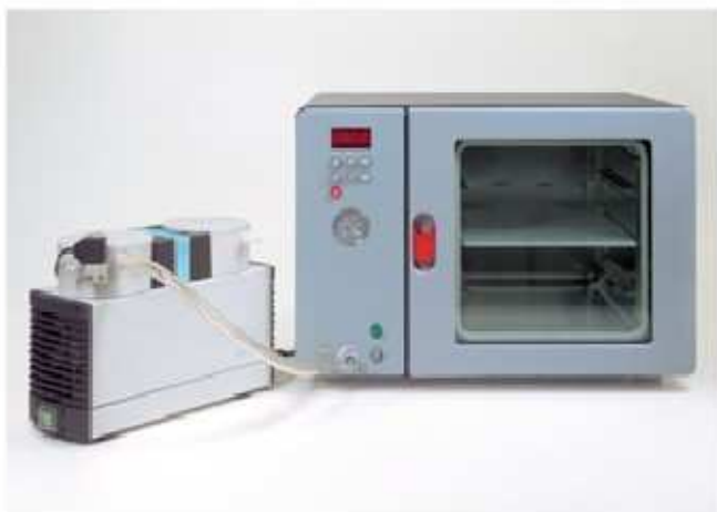
N 842.3 FT.40.18 подключенный к шкафу вакуумной сушки
