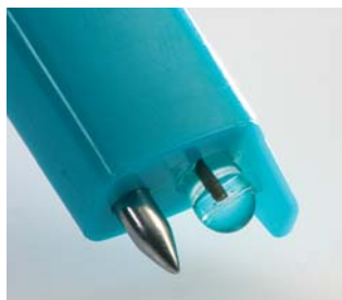
pH1 наконечник зонда для жидкостей
