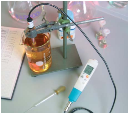
testo 206-pH3 обеспечивает подсоединение внешних зондов
