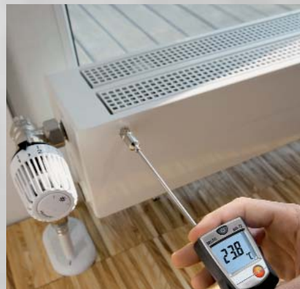
Измерения поверхностной температуры радиатора
