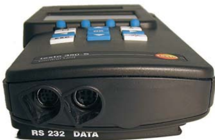
соединение с шиной данных Testo Соединение RS232
