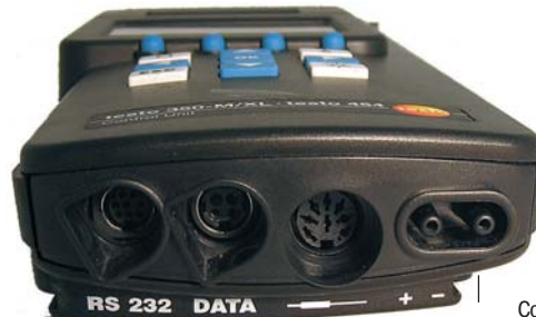
соединение с шиной данных Testo Подключение дополнительных зондов Соединение для измерения дифференциального давления/скорости потока Соединение RS232
